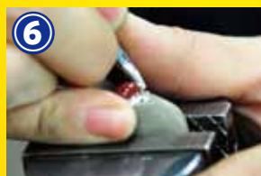
⑥ 凹凸がなくなるように金属部分を削ったら、磨きペラで磨く。
