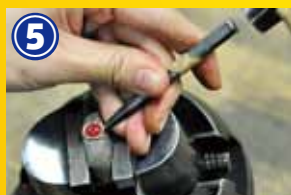
⑤ 金属部分を磨き上げたら、台に固定して、石の形に合わせて銀板を倒していく。
