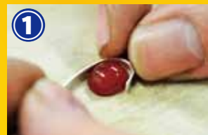
① 石に合わせて、純銀の板で枠をつくる。
