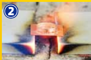
② 石が落ちないように、枠に底板を接合する。
