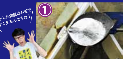
① 溶かした錫を、紙の型に流し込む。
